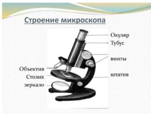
Рис. 12. Строение микроскопа
